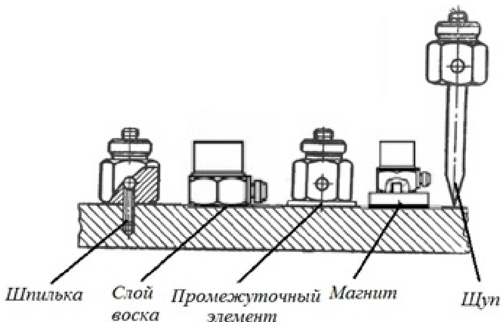
Рисунок 2.17 –Способы крепления вибрационных датчиков
