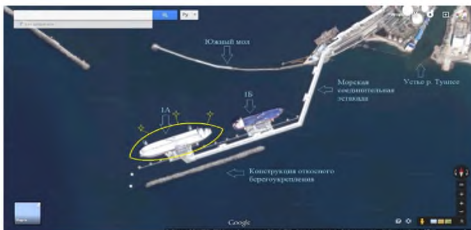
Рисунок 3.9 —Метод постановки боновых заграждений в виде кольцевания
