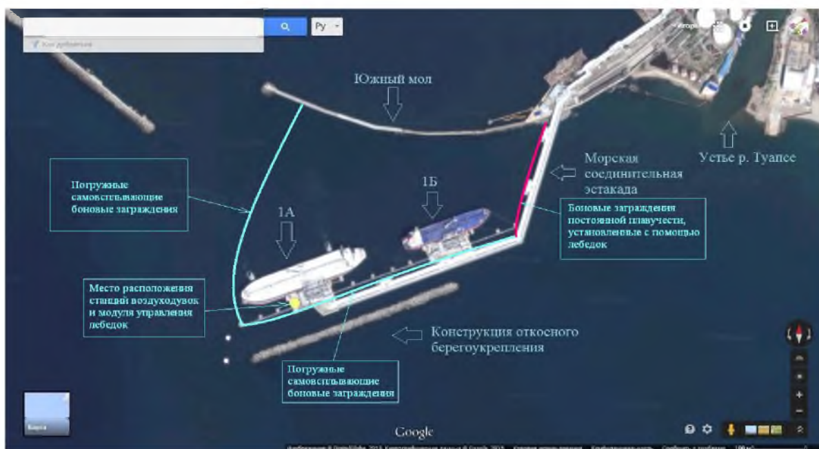
Рисунок 3.7 — Схема постановки боновых заграждений с использованием погружных самовсплывающих и постоянной плавучести, установленных с помощью лебедок
