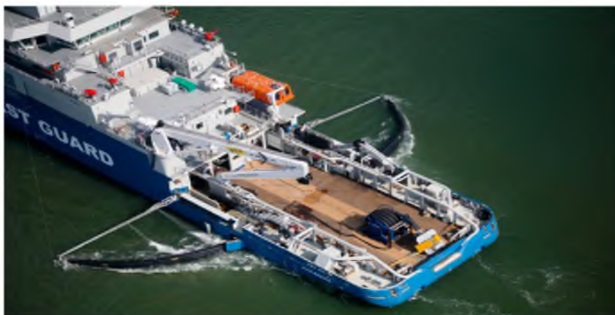
Рисунок 1.8 — Бортовая навесная нефтесборная система Lamor (LSC)
