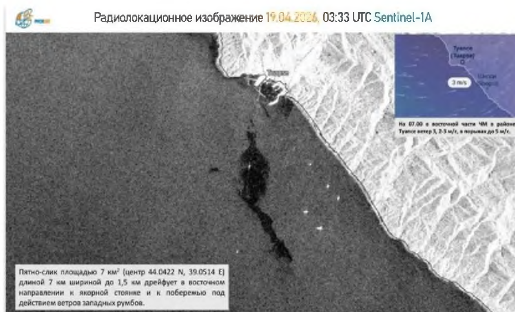
Рисунок 2.11 — Радиолокационное изображение после нефтеразлива в акватории порта Туапсе
