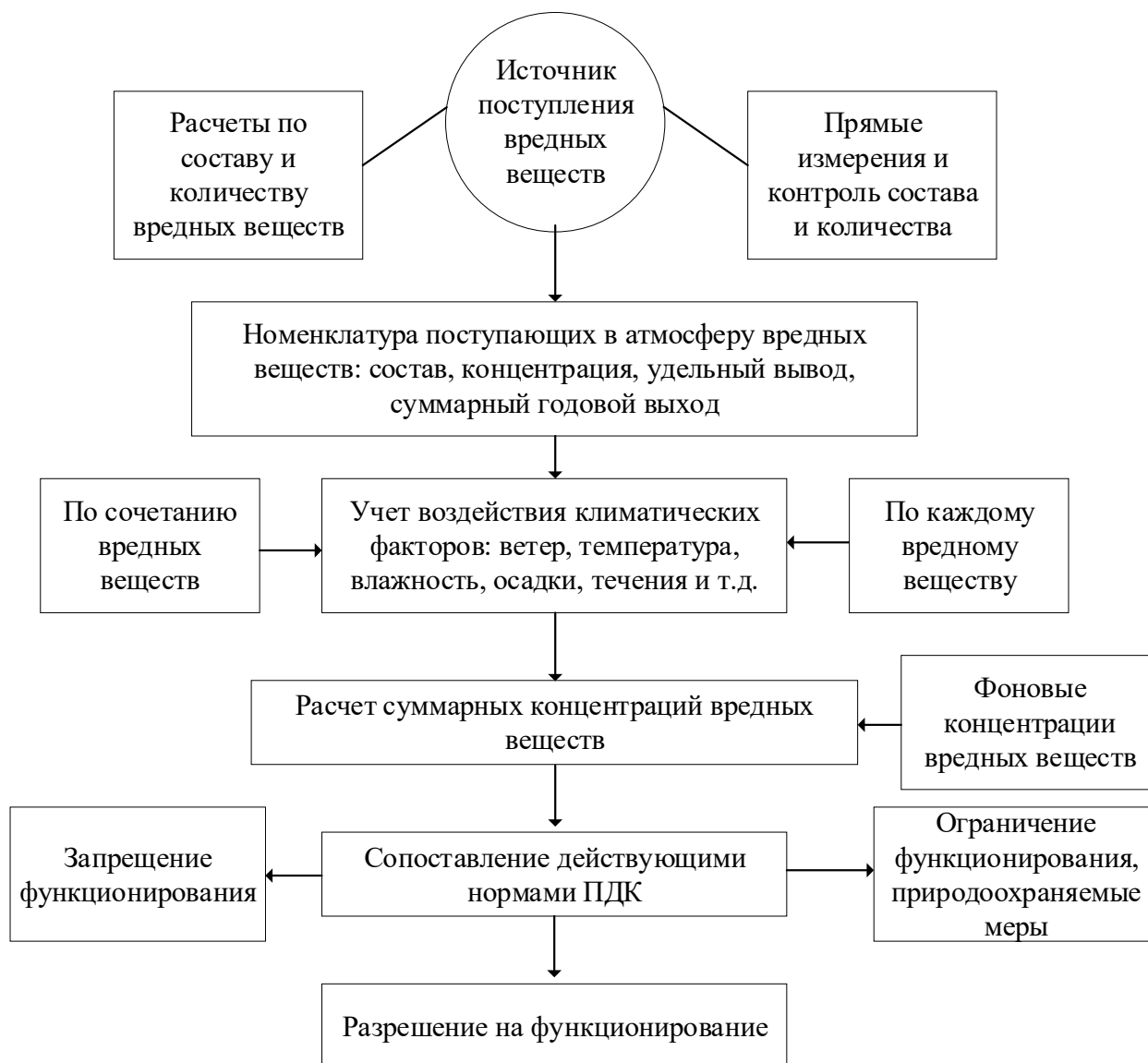
Рисунок 2 – Блок-схема алгоритма инвентаризации поступления загрязняющих веществ в окружающую среду
