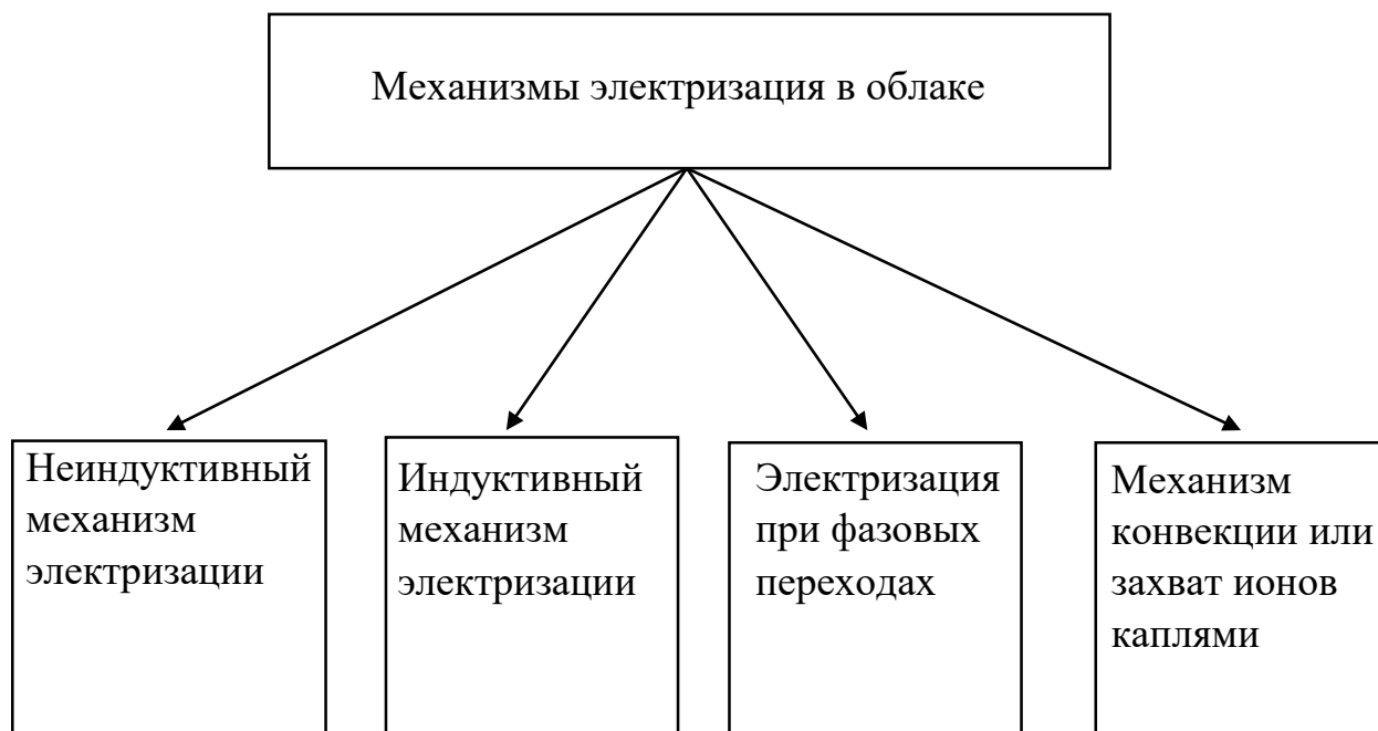
Рисунок 2.7. Схема механизмов электризации в конвективных облаках.
