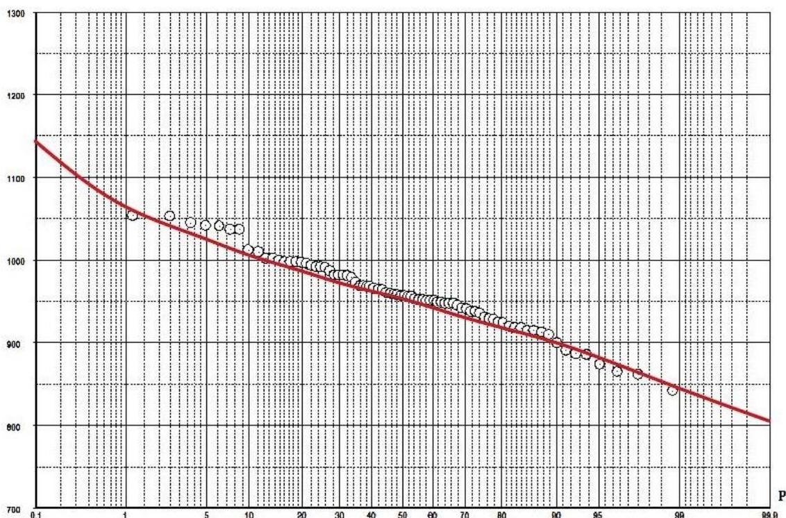
Рисунок 3.1– Эмпирическая и аналитическая кривая обеспеченностей максимальных уровней воды, р.Пур – г.Тарко-Сале
