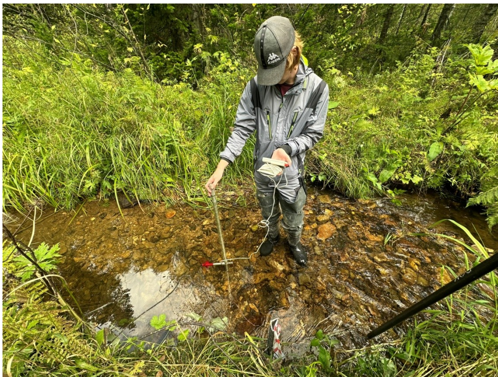
Рисунок 13. «Определение скоростей течения вертушкой ИСП-1М»
