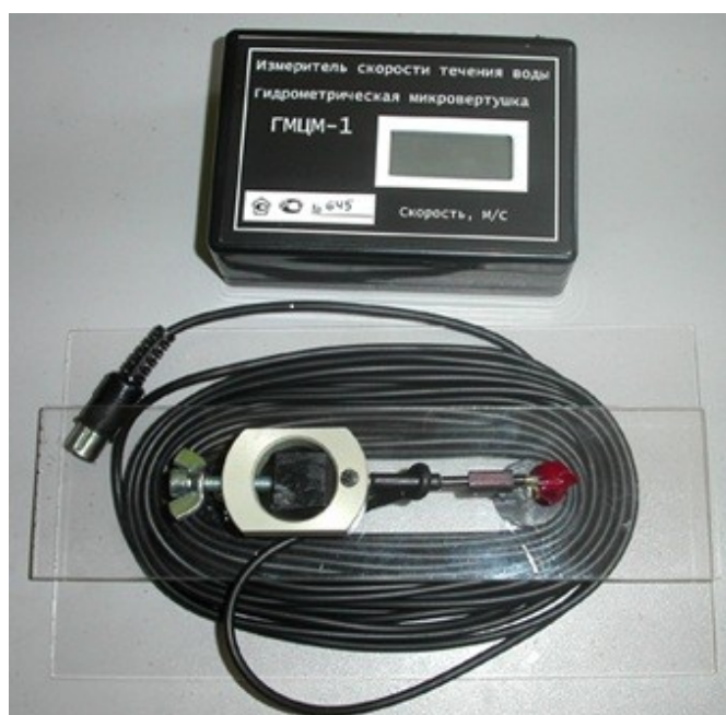
Рисунок 12. «Микровертушка ГМЦМ-1 с преобразователем»
