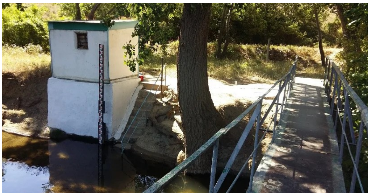
Рисунок 7. «Гидрологический пост с мостиком»
