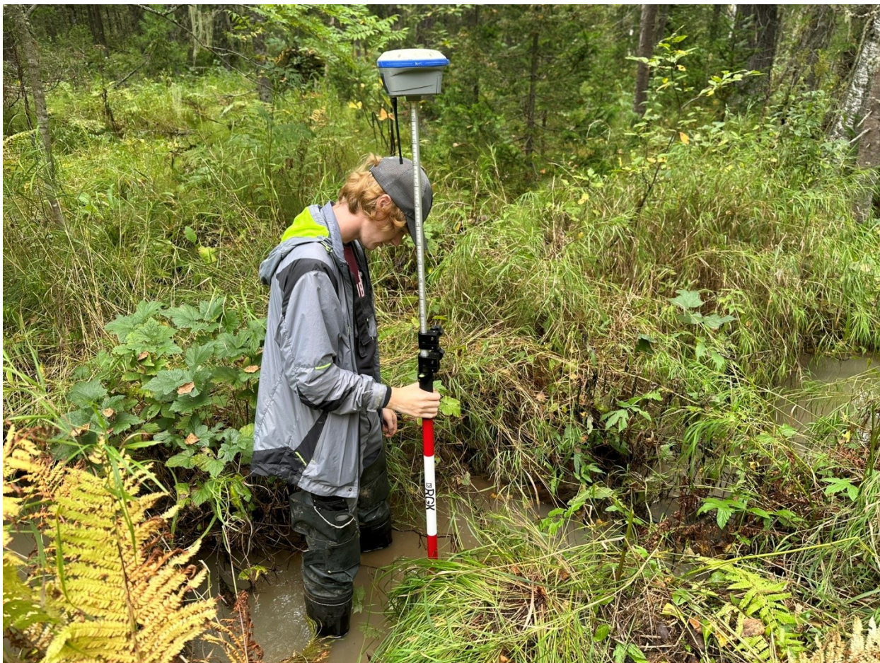
Рисунок 11. «Определение отметок водной поверхности для измерения мгновенного уклона»
