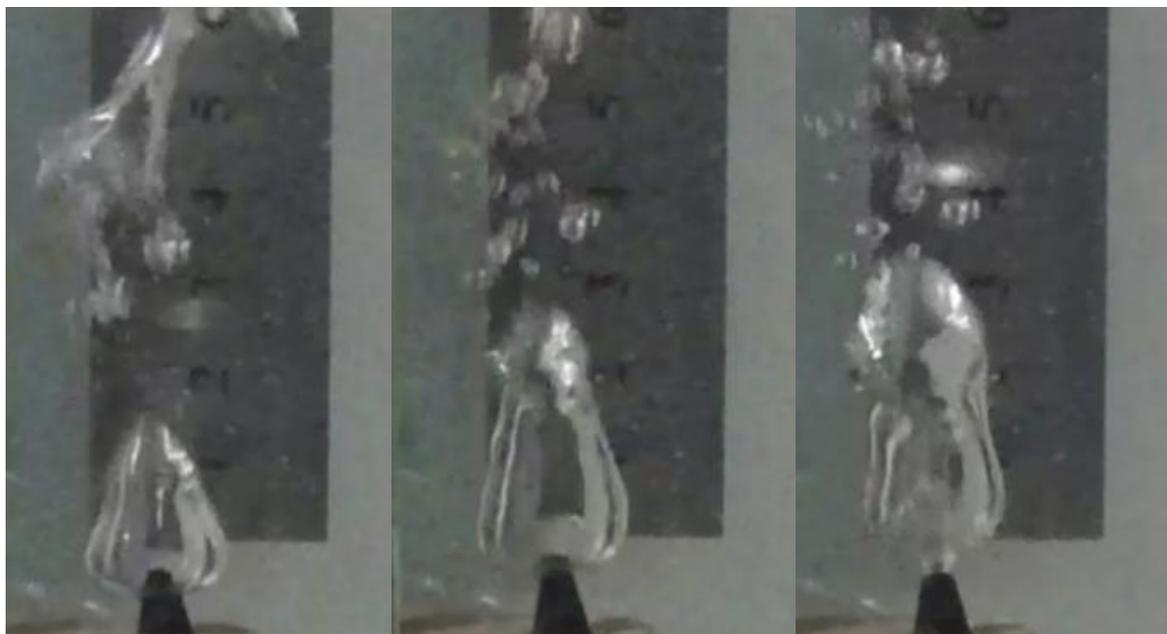
Рисунок 3.15 Образование факела на сопле.  $d = 2,6$  мм.
