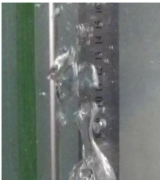
Рисунок 3.17 Распределение газовой фазы в бассейне при расходе 5 л/мин.  $d = 2,6$  мм.
