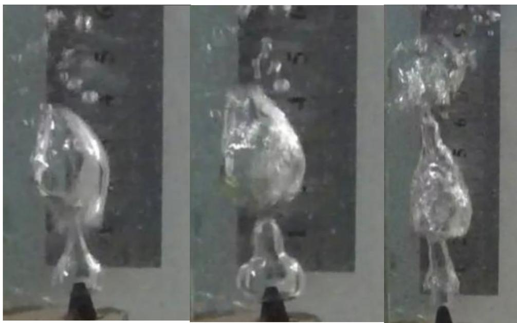
Рисунок 3.16 Отрыв большого объема от сопла и слияние с образовавшимся факелом.
