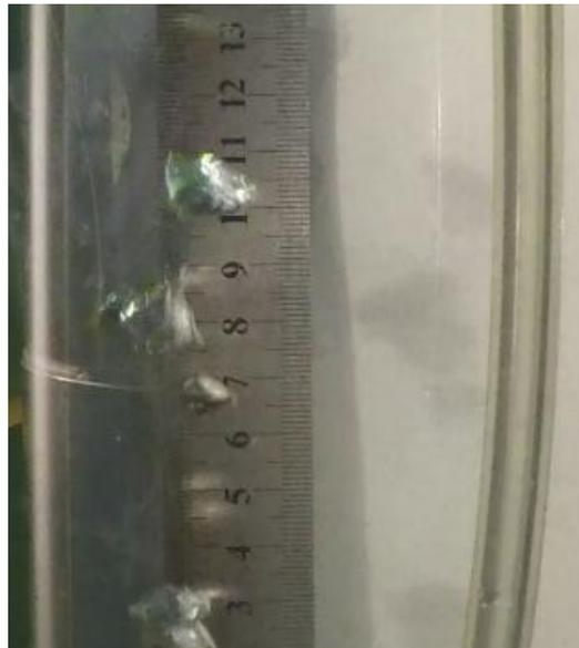
Рисунок 5 Всплытие пузырьков при расходе 0,52 л/мин. В верхней части фотографии видно, как большие объемы распадаются на более мелкие.  $d = 2.6$  мм
