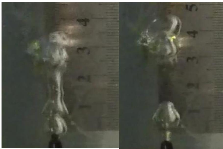
Рисунок 4 Пузыри, идущие друг за другом через сопло, сливаются и образуется воздушный объем сложной вытянутой формы, который отрывается от сопла и всплывает.  $d = 2,6$  мм.
