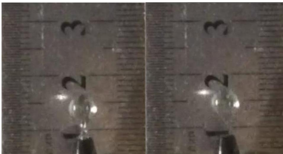
Рисунок 3.4 Утончение шейки пузыря и его отрыв от сопла.
