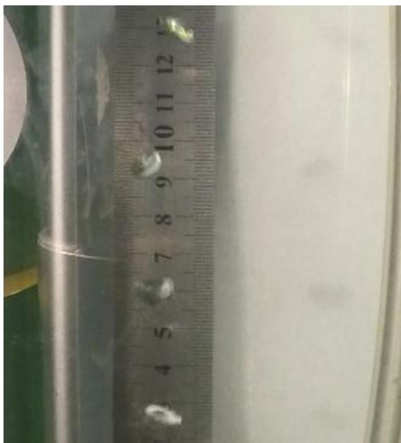
Рисунок 37 Всплытие пузырьков при расходе воздуха 0,06 л/мин, диаметр сопла 2,6 мм.
