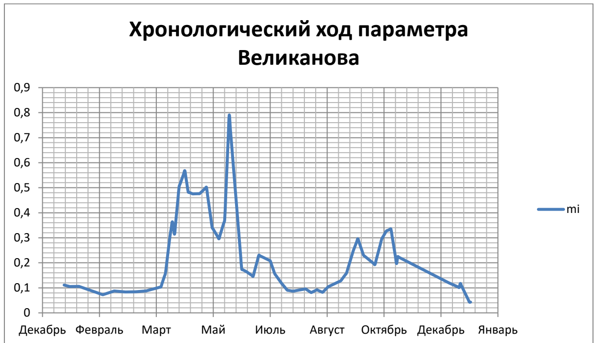
Рис. 4.1 Рассчитанный по хронологическому ходу параметра Великанова гидрограф для реки Оять за 1973 год.
