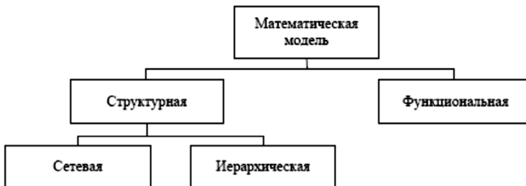
Рисунок 3.2 - Схема классификации математических моделей по характеру отображаемых свойств объекта
