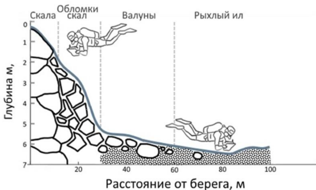
Рисунок 3.6 Описание грунта по трансекте
