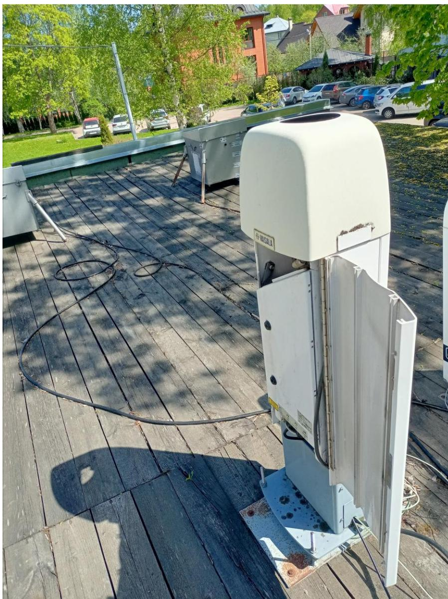
Рис. 2.2 лазерный облакомер производства фирмы VAISALA
