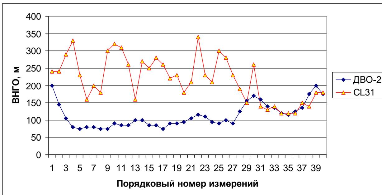
Рис. 3.1 Графики временных рядов для канала «61-200», полученные в результате использования для измерения ВНГО приборов ДВО-2 и CL31 (03.03.2011).
