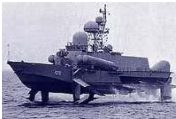
Рисунок 2.1 – Ракетный катер с автоматической системой управления подводными крыльями
