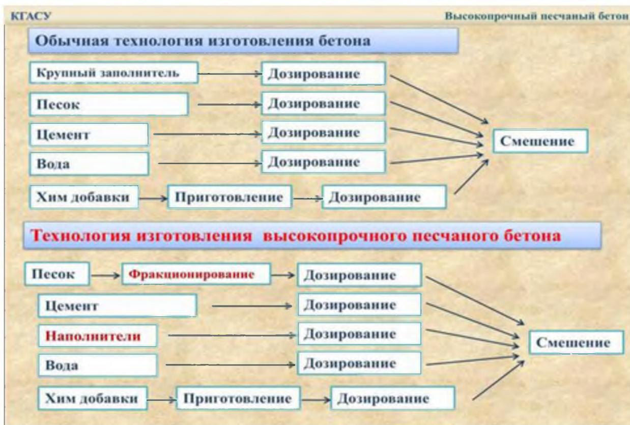
Рисунок 1.10– Технологические требования при изготовлении бетона
