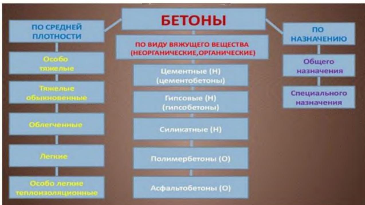
Рисунок 1.9 – Классификация бетонов
