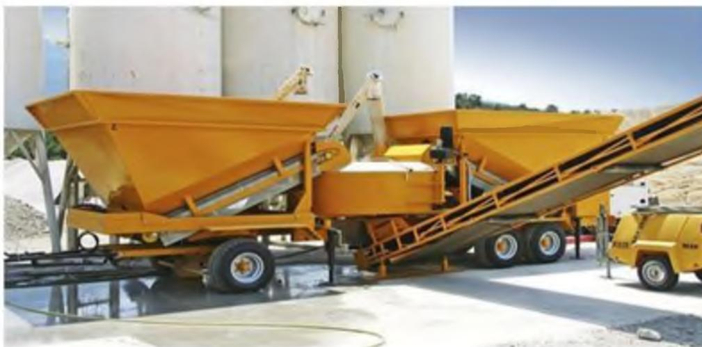
Рисунок 1.2 — Пример мобильного устройства по изготовлению бетона
