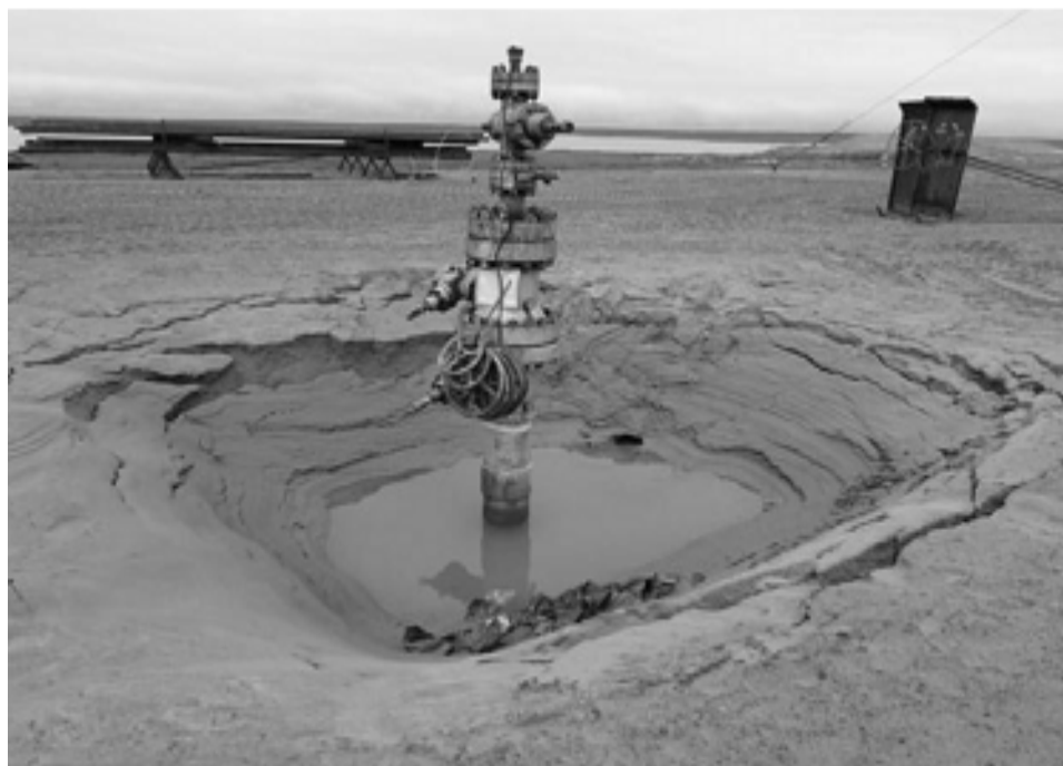
Рисунок 3.2– Приустьевая воронка скважины [5].
