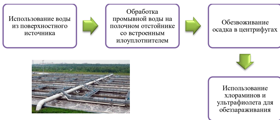
Рисунок 9 – Блок-схема двухступенчатой технологии водоподготовки в Санкт-Петербурге
