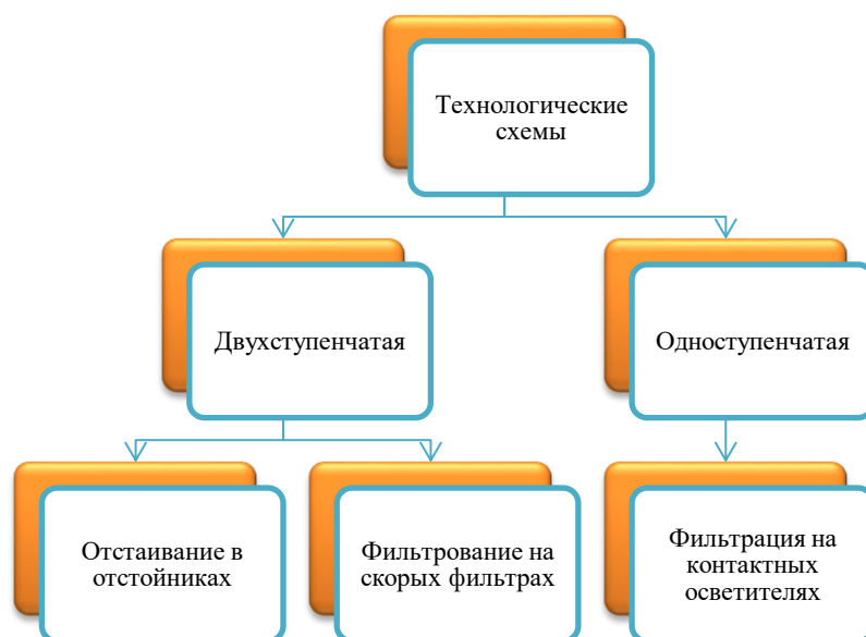
Рисунок 8 – Технологические схемы очистки питьевой воды в Санкт-Петербурге
