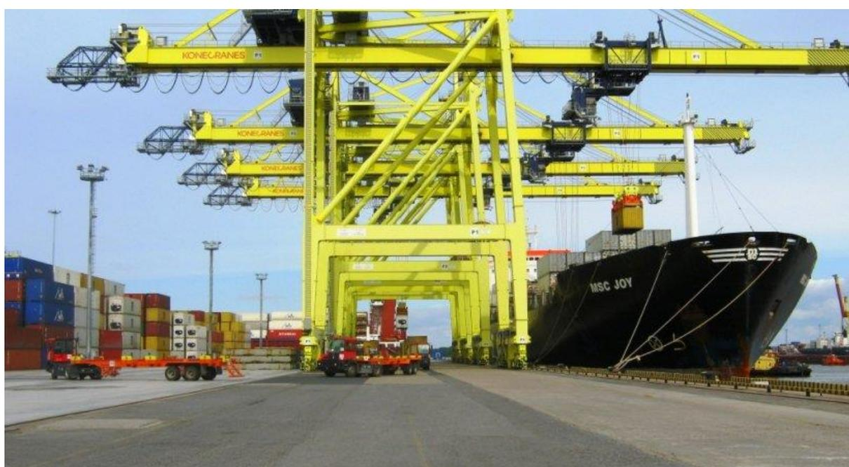
Рисунок 1.2 – Причальный контейнерный перегружатель Panamax.
