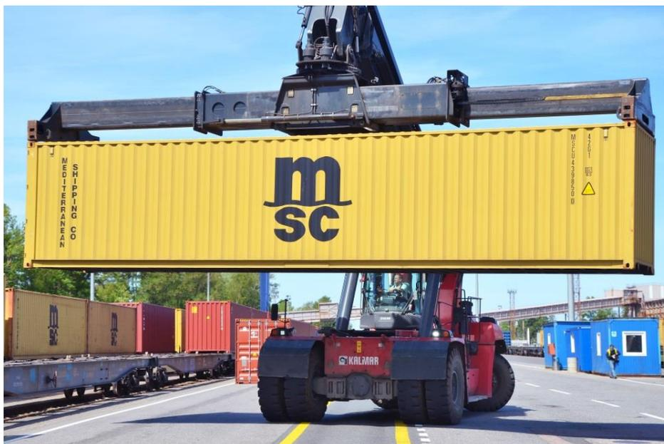
Рисунок 1.6 – Ричстакер «Kalmar» DRT450
