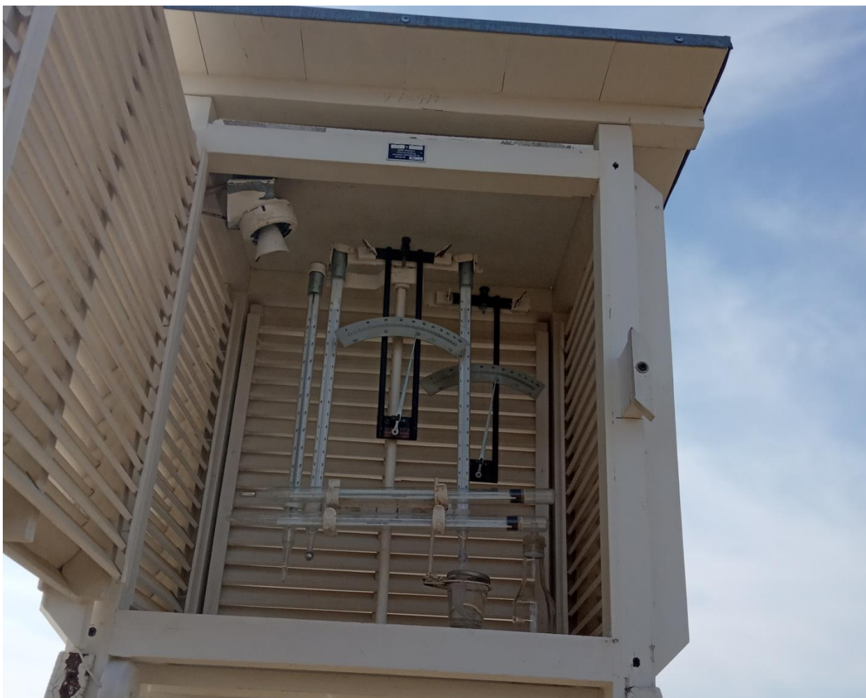
Рисунок 2.3 – Термометры для измерения температуры воздуха
