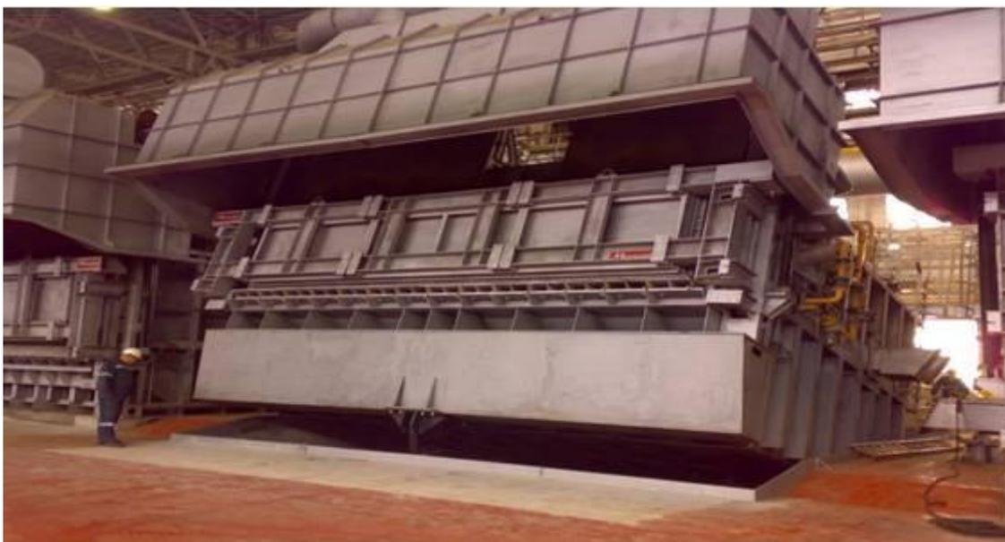
Рисунок 10 – Поворотно-наклонная печь емкостью 60 тонн
