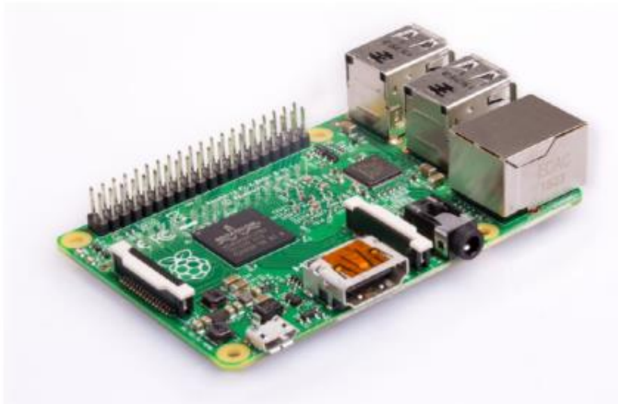
Рис. 2.2. Микропроцессорное устройство ARM архитектуры Raspberry Pi, на базе которого был сконструирован опытный образец мобильного устройства (снимок производителя).
