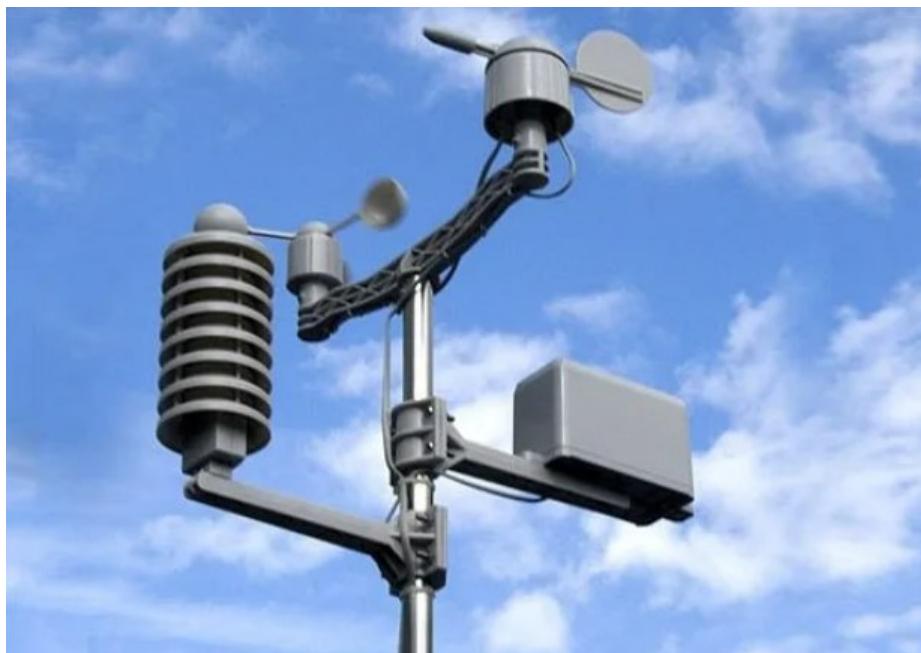
Рисунок 2.1 – Внешний вид АДМС
