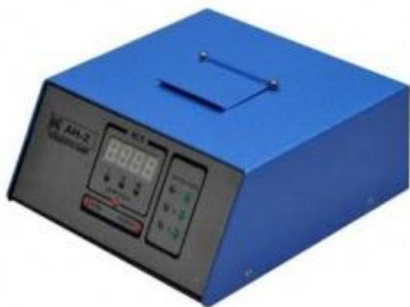
Метод измерения заключается в выделении нефтяных компонентов из воды экстракцией четыреххлористым углеродом, хроматографическом отделении углеводородов от соединений других классов на колонке с оксидом алюминия и количественном оценивании их массовой концентрации по
