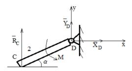
Система уравнений равновесия состоит из трех уравнений: суммарные проекции всех сил на оси *Ох* и *Оу* равны нулю и суммарный момент относительно, например, точки D, тоже равен нулю. Тогда можем записать
