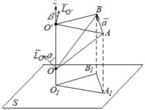
Моментом вектора  $\vec{a}$  относительно оси l называется проекция на эту ось момента данного вектора относительно любой точки O оси. В частности, моментом вектора  $\vec{a}$  относительно координатных осей являются проекции на эти оси момента вектора относительно начала координат.
