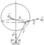
Из приведенного рисунка видно, что модуль скорости  $v = \omega h = \omega r \sin \alpha$  совпадает с модулем векторного произведения  $\vec{\omega} \times \vec{r}$ . Направление скорости тоже совпадает с направлением этого векторного произведения. Поэтому
