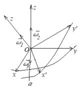
Скорость любой точки твердого тела определяется по той же формуле  $\vec{v} = \vec{\omega} \times \vec{r}$ , где
