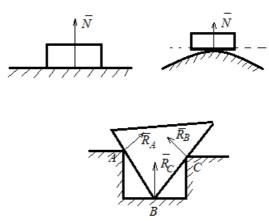
2. Если твердое тело упирается острием в угол (лестница, вид сбоку), то это ограничение следует рассматривать как двойное: угол препятствует движению и в сторону и вниз. Поэтому в общем случае вводят две неизвестных реакции опоры, а затем можно вычислить их равнодействующую, которая является их геометрической суммой.
