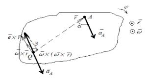
Пусть A — некоторая точка твердого тела, имеющая ускорение  $\overrightarrow{a_A}$ . Проведем луч из точки A под углом  $\alpha$  к направлению вектора ускорения, откладывая его в сторону вращения, если оно ускоренное. При этом
