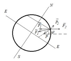
На приведенном рисунке  $\overrightarrow{F_1}$  - сила притяжения Земли. Она направлена приблизительно к центру Земли и является равнодействующей всех сил притяжения, с которыми действуют все точки земного шара.  $\overrightarrow{F_2}$  - сила притяжения к Солнцу. Она направлена по прямой, соединяющей Солнце и Землю. По модулю
