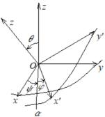
Угол Φ называется углом собственного вращения,  $\psi$  – угол прецессии,  $\theta$  – угол нутации. Если меняется только угол  $\varphi$ , то происходит вращение вокруг оси 0z', поэтому z'ось называется осью собственного вращения. Если меняется только угол  $\psi$  – вращение вокруг оси Oz (ocbnрецессии). Если же меняется только угол  $\theta$ вращение вокруг оси  $0\alpha$ , которая получается при пересечении координатных плоскостей Oxy и Ox'y' (ось нутации).
