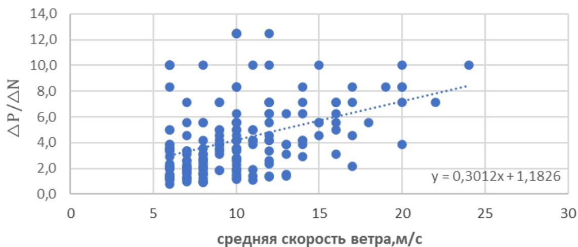
Рисунок 60 – Диаграмма зависимости средней скорости ветра от барического градиента в осенний период.
