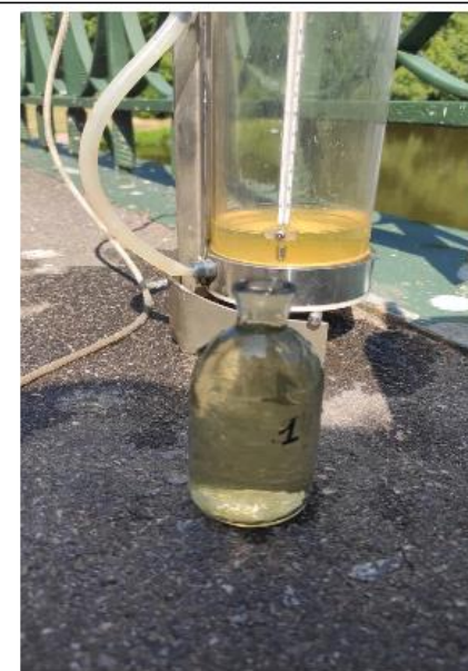
Сбор пробы воды в кислородную склянку для последующей фиксации растворенного кислорода
