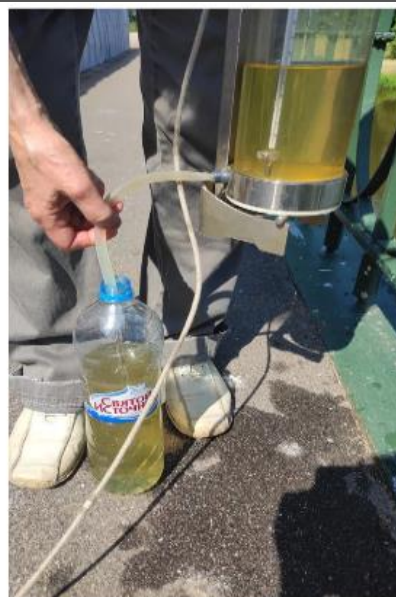
Сбор пробы воды в пластиковую тару с Плотины Гаусса батометром Limnos в разобранном виде
