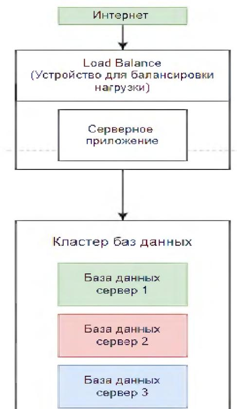
Рисунок 2.5 - Схема распределенной архитектуры
