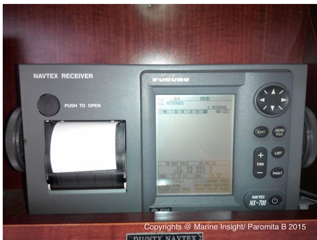
Рис. 3.1 - Внешний вид приемника NAVTEX.
