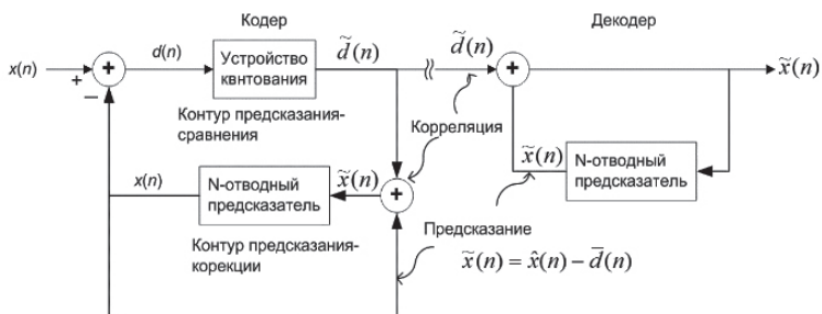
Рис. 14.1. DPCM-преобразователь голоса в код.
