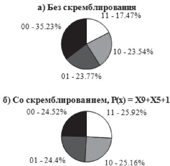
Рис. 14.9. Диаграмма распределения OFDM ячеек для изображения: а) без применения скремблера, б) со скремблером.
