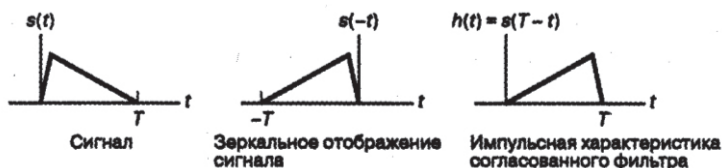
Рис. 11.2. Импульсная характеристика согласованного фильтра.
