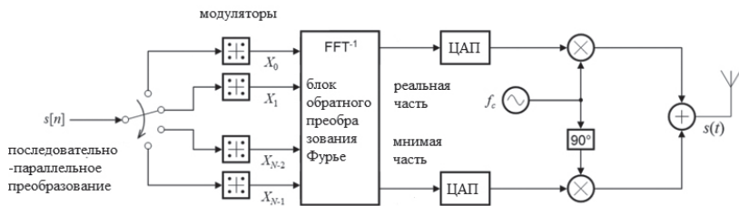
Рис. 10.2. Передатчик OFDM сигнала.
