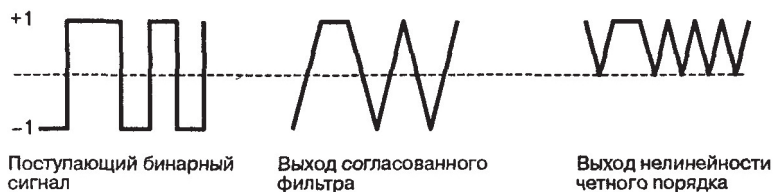
Рис. 12.3. Иллюстрация процессов, происходящих в разомкнутом символьном синхронизаторе.
