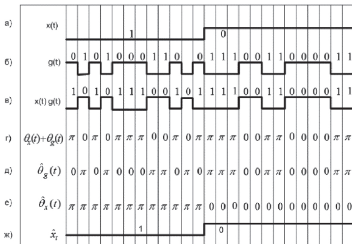
Рис. 10.11. Пример расширения спектра методом прямой последовательности: а) исходные двоичные данные; б) кодовая последовательность; в) переданная последовательность; г) фаза переданной несущей; д) фазовый сдвиг, выполненный кодом приемника; е) фаза принятой несущей после сужения; ж) демодулированный информационный сигнал.
