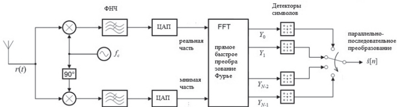
Рис. 10.4. Приемник OFDM сигналов.
