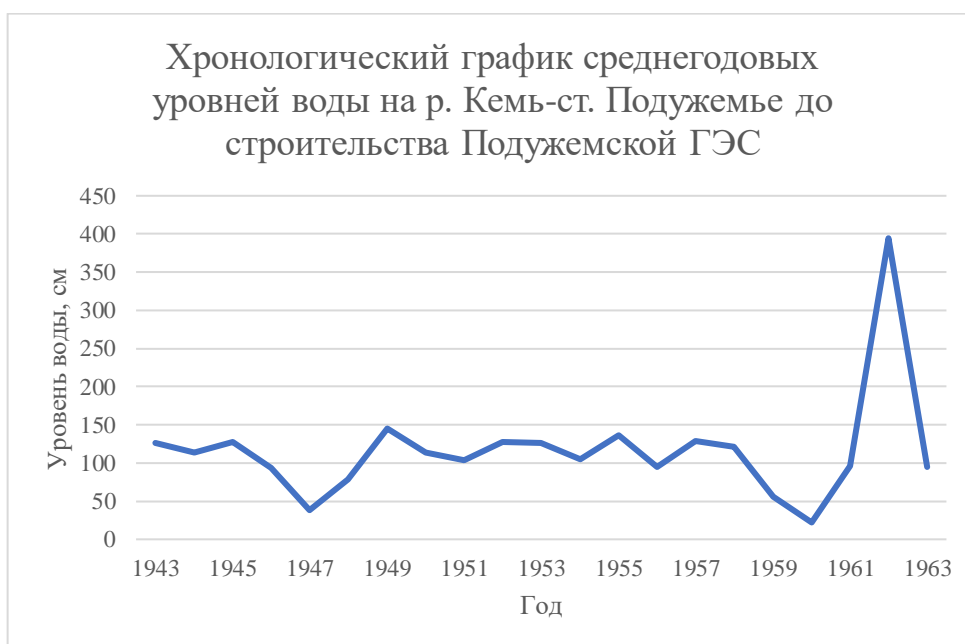
Рисунок 11 – Хронологический график среднегодовых уровней воды на р. Кемь – ст. Подужемье до строительства Подужемской ГЭС, за 1943 – 1963 года
