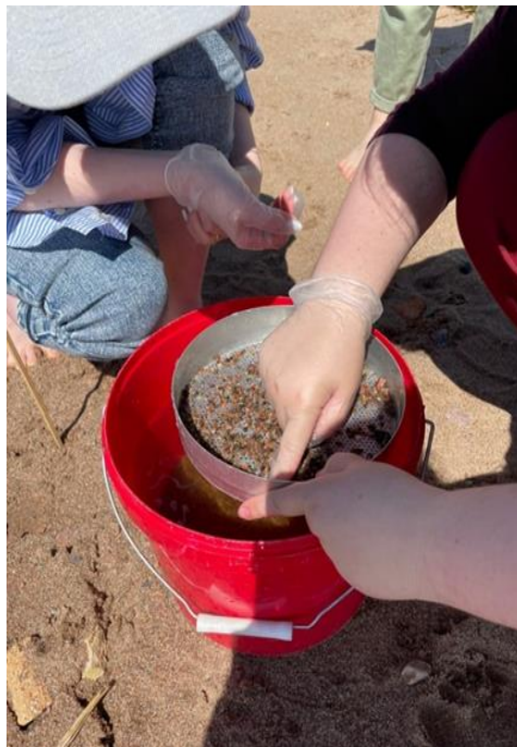
Рисунок 2.3 – Просеивание проб через сито на пляже парка 300-летия После выполнения отбора проб заполняется бумажные протоколы, в них заносятся следующие данные:
