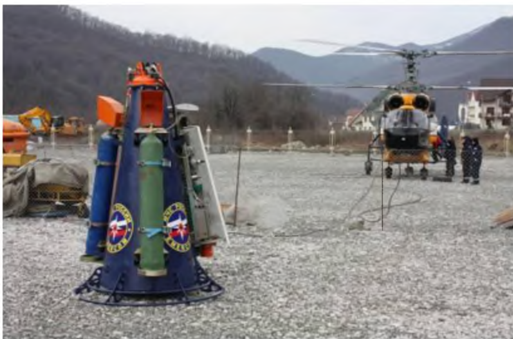
Рисунок 2.3 — Мобильная противолавинная установка Daisy bell
