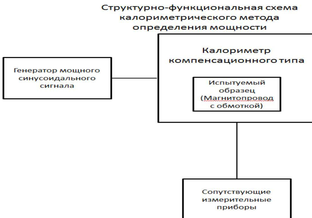
Рисунок 3 - Структурно-функциональная схема калориметрического метода определения мощности
