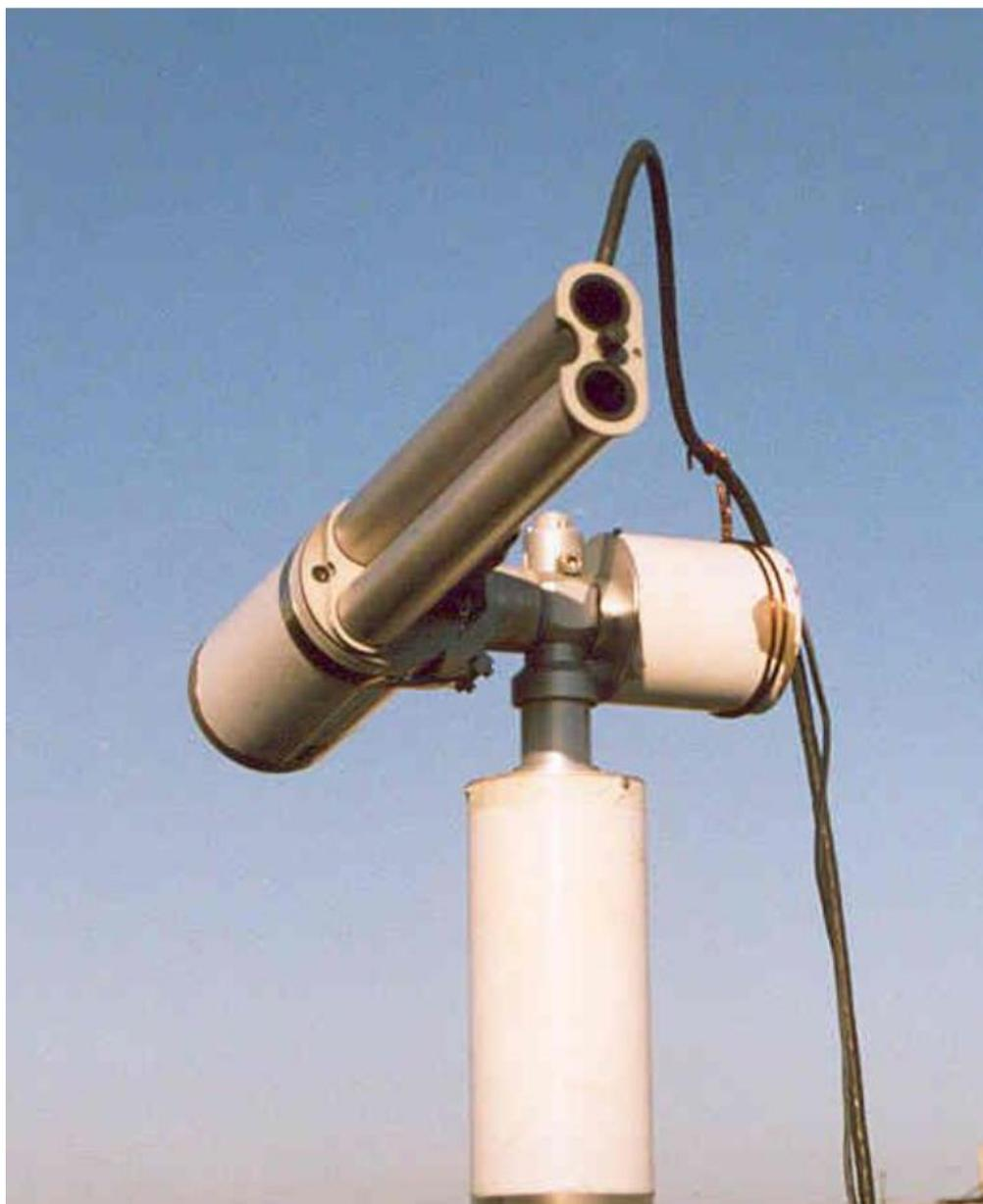
Рис. 5.3 - Солнечный автоматический фотометр CimelCE-318
