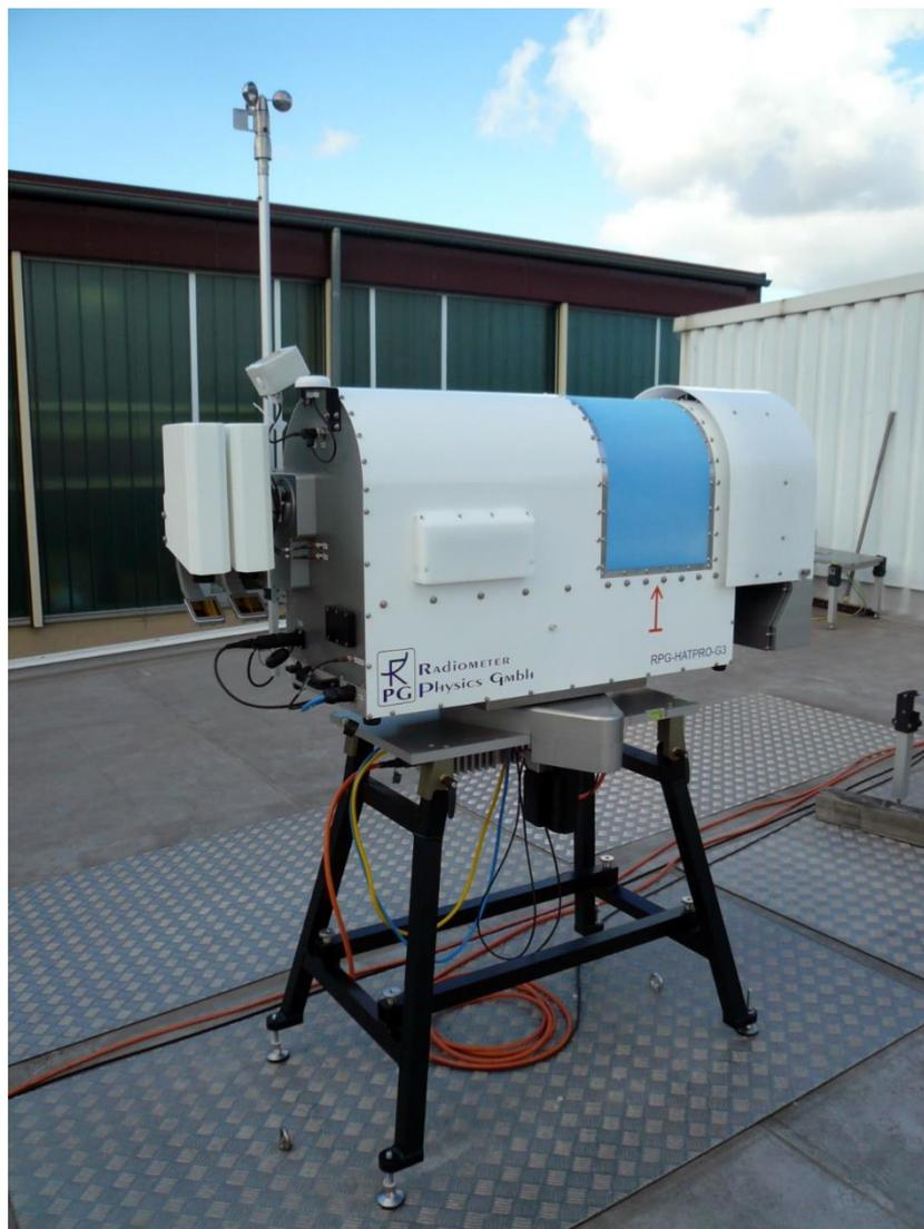
Рис. 5.2 - Микроволновый радиометр RPG-HATPRO
