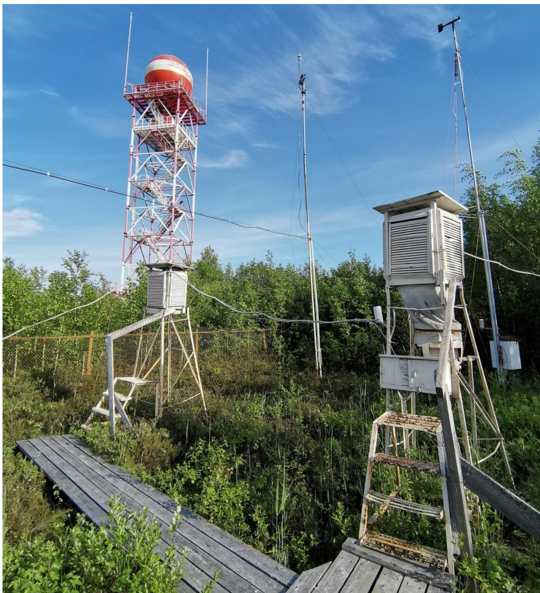
Рисунок 2.10 – Психрометрическая будка аэрологической станции в Архангельске
