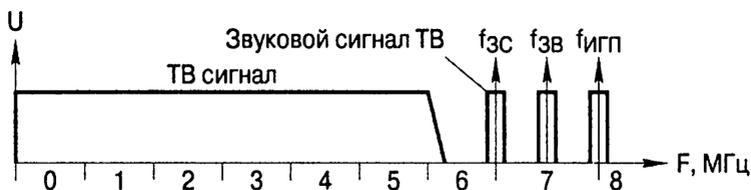
Рис. 4.6. Спектр частот сигналов в спутниковой системе связи «Орбита-2» [1]
