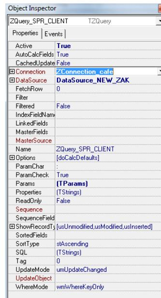
**Рисунок 8 Подключение компонента ZQuery к ZConnection**
