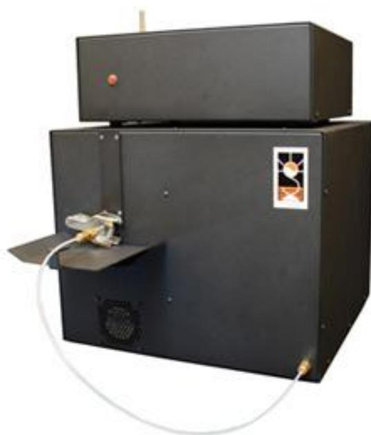
Рисунок 2.1 - Термооптический анализатор (Sunset Laboratory Inc., USA)
