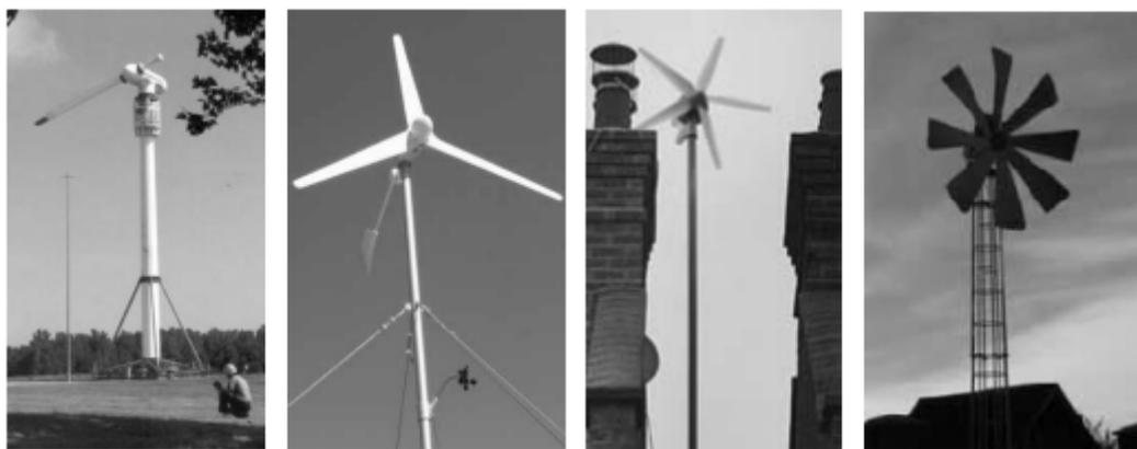
Рисунок 13. Ветрогенератора с горизонтальным ротором[12]
