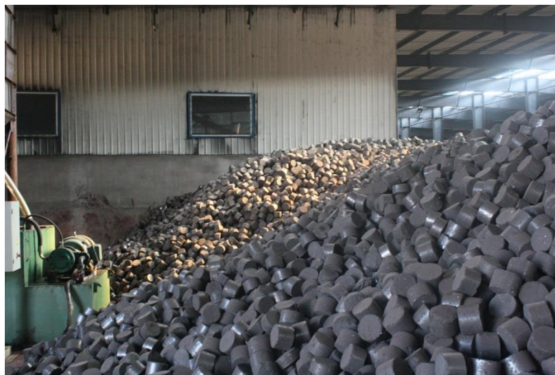
Рисунок 5 – Готовая продукция переработки металлической стружки
