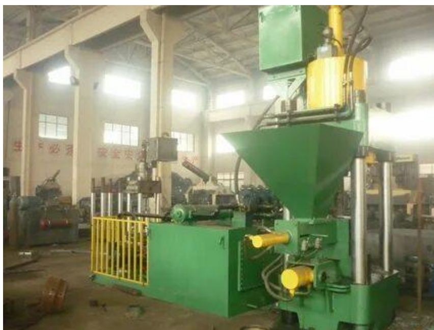
Рисунок 4 – Линия для брикетирования стружки [24]
