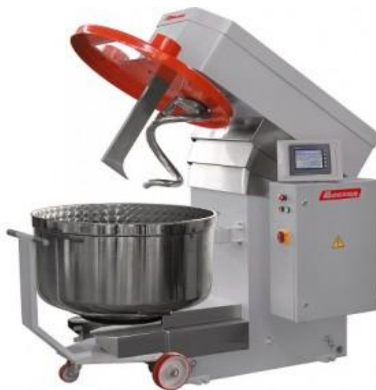
Рисунок 13 - Тестомесильная машина Прима-300
