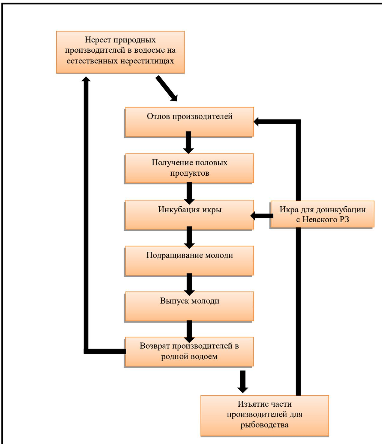
Рис.7 - Технологическая схема воспроизводства лосося от стадии отлова производителя до выпуска (составлена автором)
