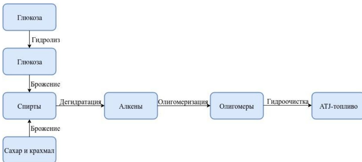
Рисунок 9 – Схема процесса производства АТJ-топлива
