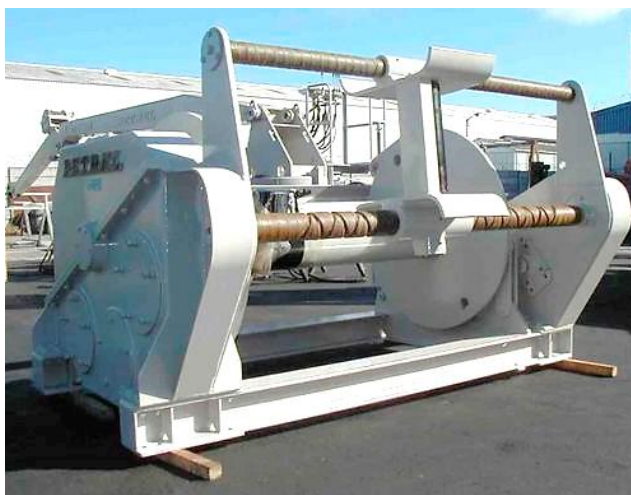
Рисунок 2.27 – Лебедка для судна PW-125-LSA-SF3(B45)
