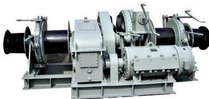
Рисунок 2.16 - Электрический брашпиль Zhongyuan
