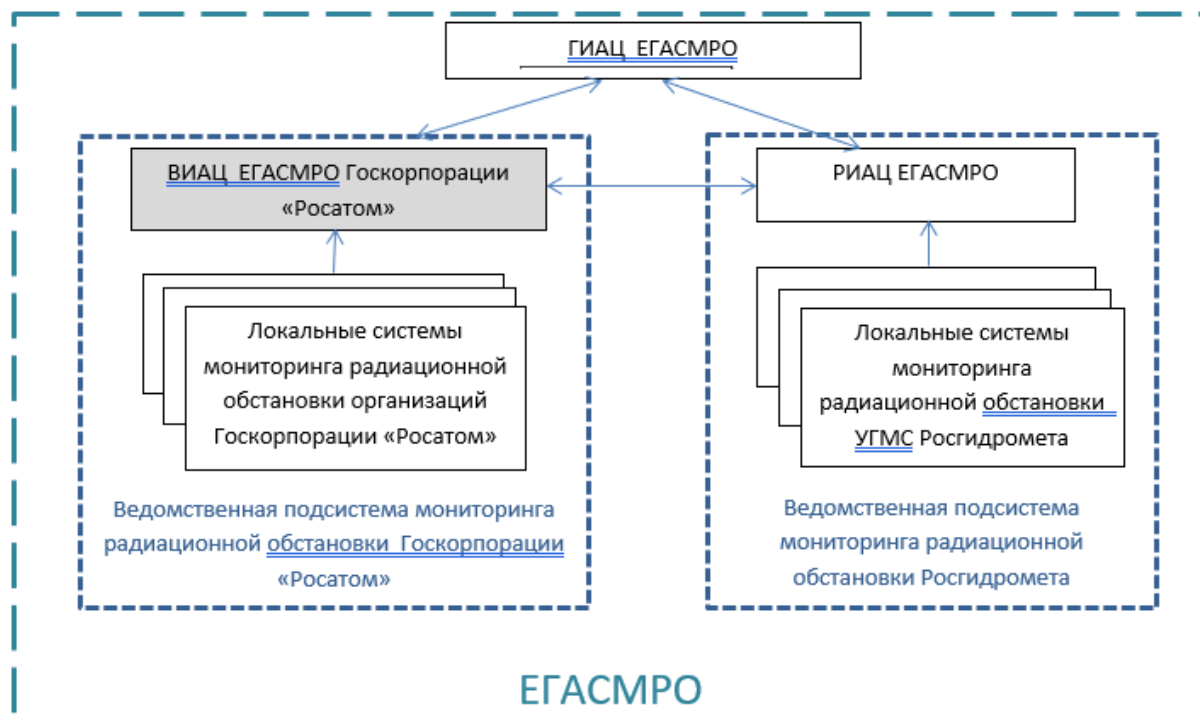
Рисунок 6 – Структура единой государственной автоматизированной системы мониторинга радиационной обстановки
