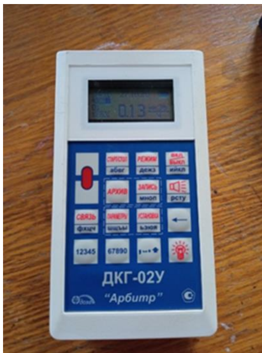
Рисунок 7 – Дозиметр ДКГ-02У предназначенный для оперативной оценки радиационного фона, измерения интенсивности гамма - и рентгеновского излучения.
