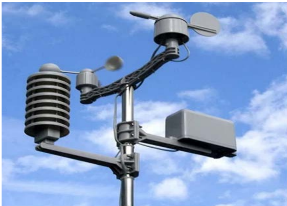
Рисунок 2.4 – Автоматическая дорожная метеорологическая станция
