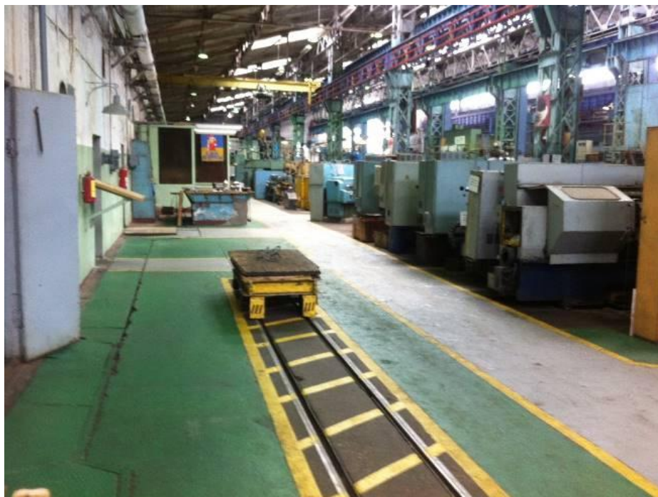
Рисунок 33 - Результат мероприятий по внедрению 5S Появились удобные тележки для перемещения заготовок.
