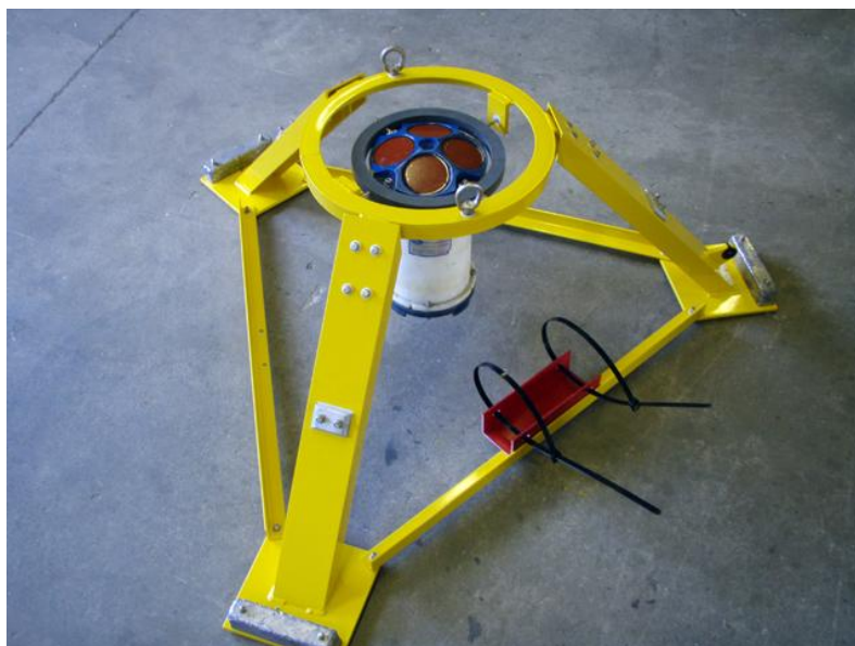
Рисунок 2.3 – Немагнитная стойка «Gimbale ADCP Platforms»
