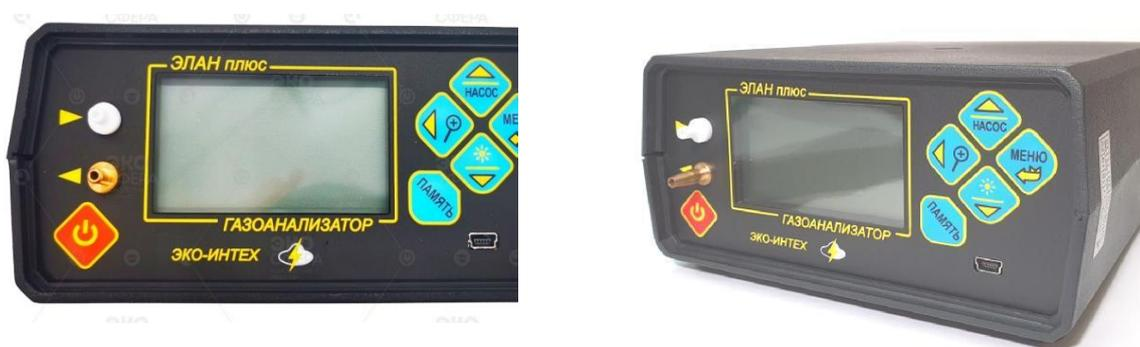
Рисунок 14 – Газоанализатор ЭЛАН плюс
