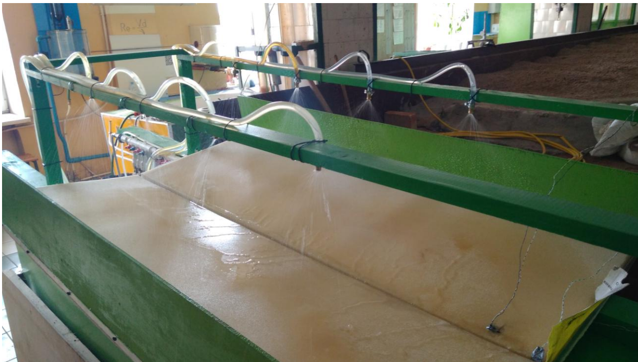
Рисунок 3.13 – Процесс подачи на установку осадков
