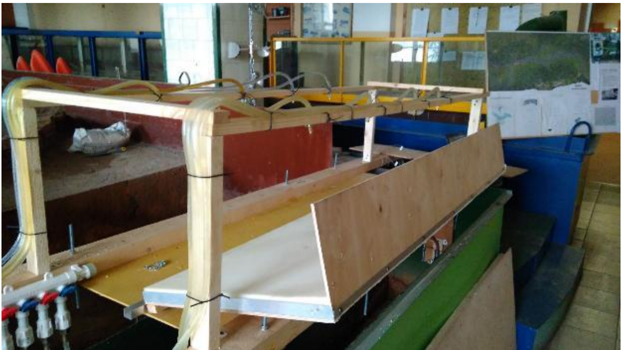
Рисунок 3.5 – Установка форсунок и берегов на регулируемые шпильки
