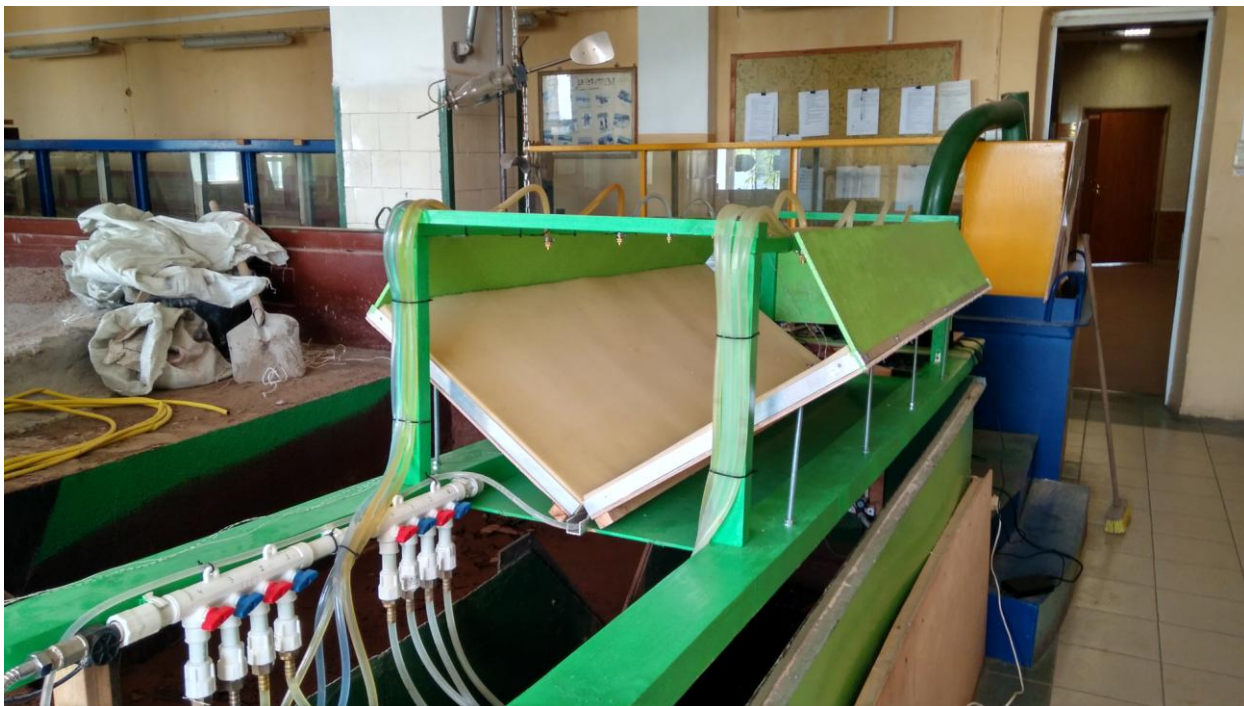
Рисунок 3.15 – Уклон водосбора 35^\circ , пористая и увлажненная подстилающая поверхность
