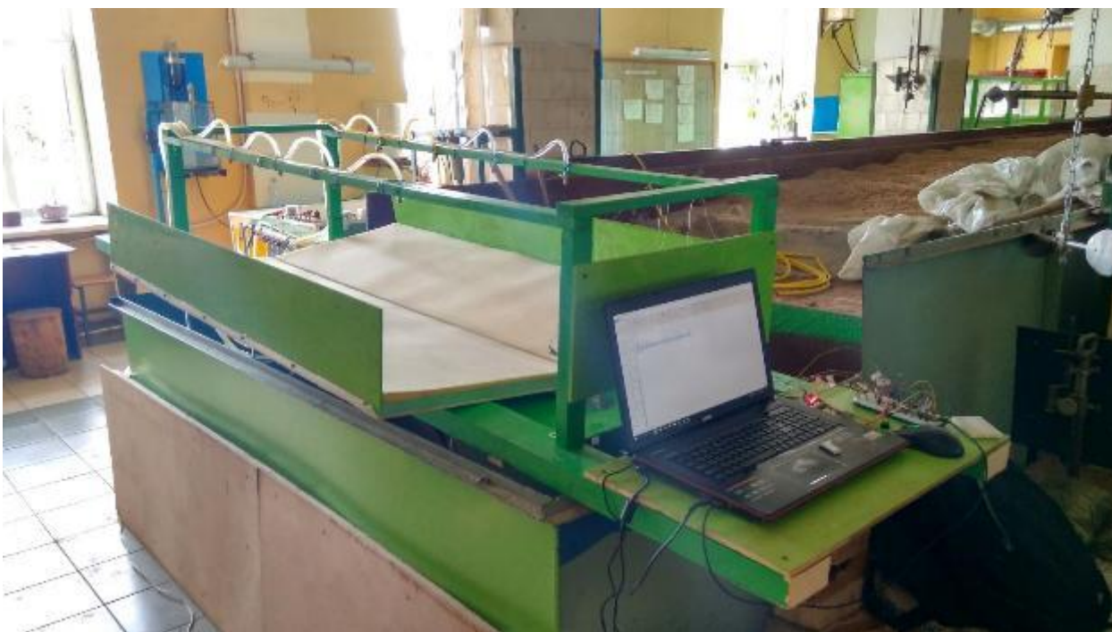
Рисунок 3.14 – Процесс измерения характеристик водосбора после выпадения осадков
