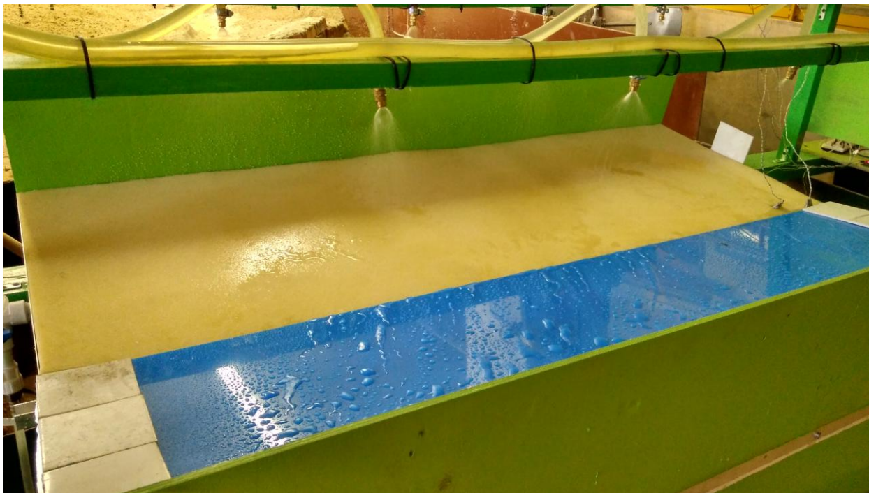
Рисунок 3.17 – Уклон водосбора 5^\circ , 50% - ое перекрытие водосбора гладким материалом
