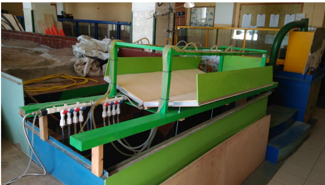
Рисунок 3.18 – Уклон водосбора 15^\circ , пористый и сухой водосбор
