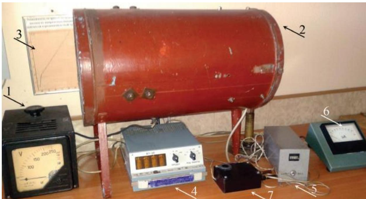
Рисунок 3.1. Оборудование для исследования ротоанемометров [6].
