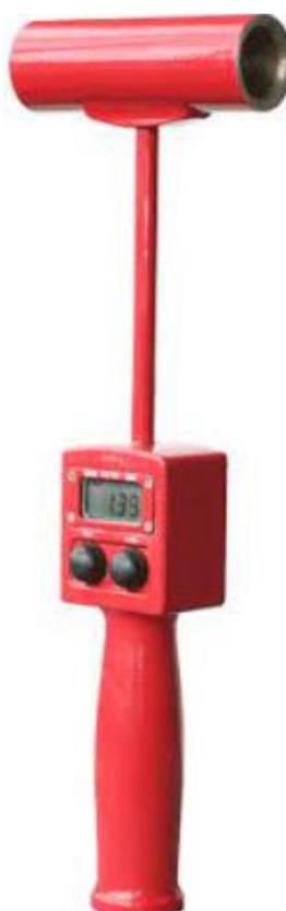
*Рисунок 1.7. Портативный акустический анемометр АПА-1*
