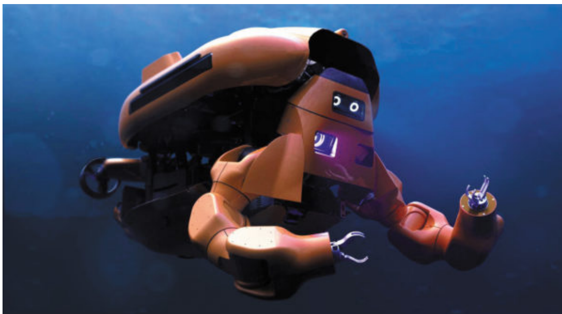
Рисунок 1.4.2 - Подводный робот, предназначенный для проверки морских нефтегазовых активов без необходимости использования дорогостоящих надводных вспомогательных судов
